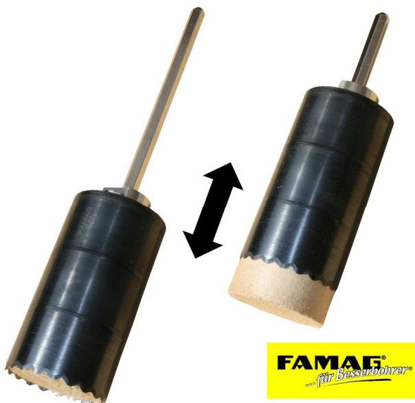
Jetzt kommt das Beste: Das Auswerfen des Sägekerns ist im Handumdrehen möglich, indem Sie die Lochsäge einfach nach dem Schneiden auf dem Auswerferschaft nach hinten schieben. Das ist besonders erfreulich denn die Dämmstoffe neigen zum Zerbröseln wenn man den „Bohrkern“ wie bisher mit Schraubendrehern und viel Geduld „rausfummeln“ muss.
